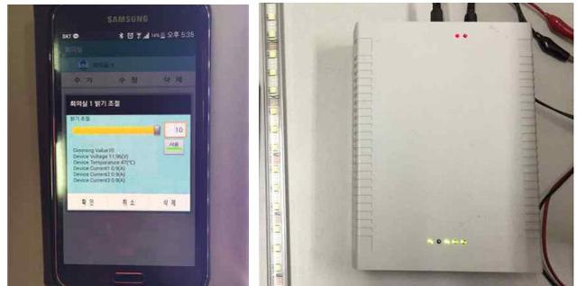
(그림 4) 컨버터와 LED 조명 연결 및 테스트 셋팅
